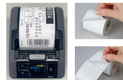
台紙なしラベルの携帯プリンター（左）、台紙なしラベル（右上）と台紙ありラベル（右下）
